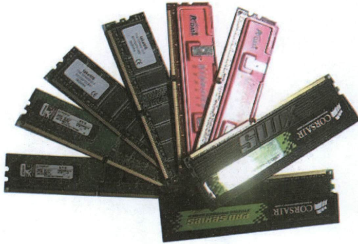
الشكل (2-33) الذاكرة العشوائية RAM
